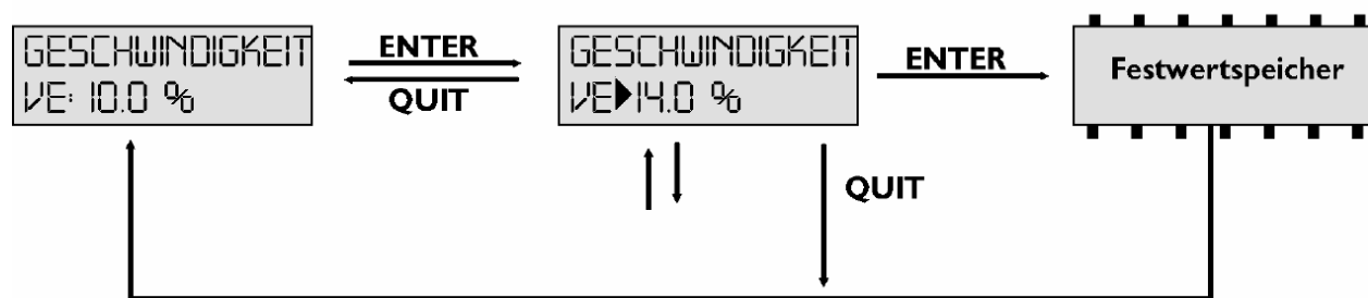
Bild 5.3 Die Abänderung von Daten in den Untermenüs: Vom Anzeige- in den Änderungsmodus Mit ENTER; Ändern der Werte mit den Pfeiltasten, dauerhaft Abspeichern mit ENTER.
